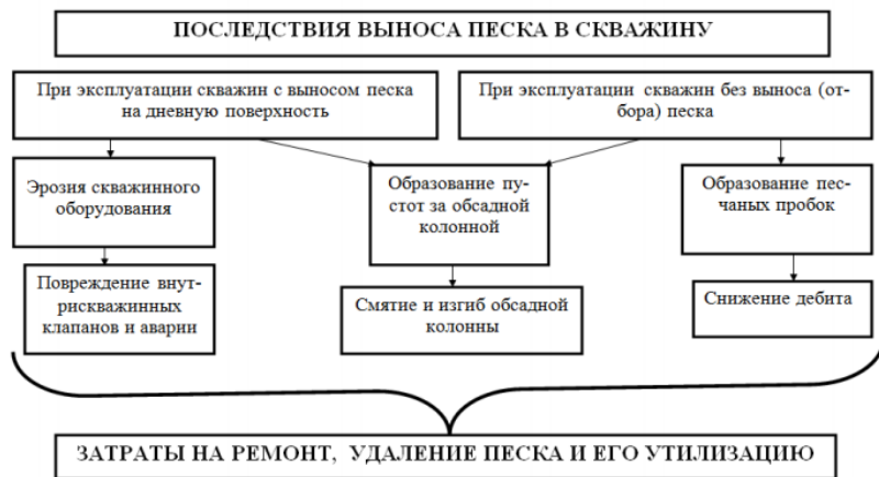
Рисунок 2 – Последствия выноса песка в скважину
