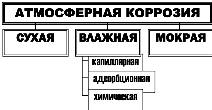
Рисунок 1 – Обобщённая система классификации атмосферной коррозии металлоизделий
