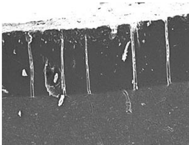
Рисунок 1 – Покрытие из анодного оксида алюминия (x1000)
