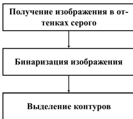
Рисунок 2 – Процесс предварительной обработки изображений
