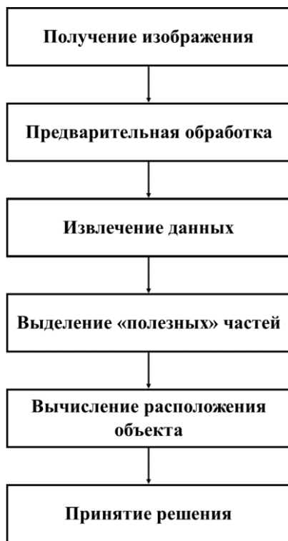
Рисунок 1 – Схема программы с использованием OpenCV
