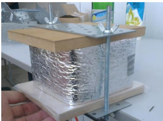
Рисунок 1 – Форма для смораживания образцов фундаментов и проведения испытаний
