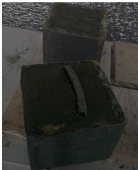
Рисунок 3 – Образцы фундамента до и после испытания на срез по поверхности смерзания с грунтовым раствором
