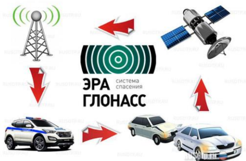
Рисунок 2 – Принцип работы системы экстренного реагирования ЭРА-ГЛОНАСС
