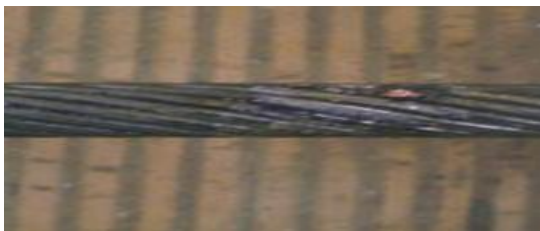
Рисунок 1 – Результат испытания на стойкость к удару молнии с переносимым зарядом 111 Кл
