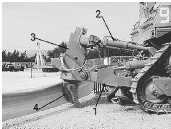
Рисунок 1 – Рыхлитель (риппер) на тягаче с трехточечной подвеской
