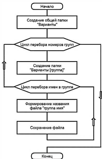
Рисунок 1 – Блок схема поставленной задачи
