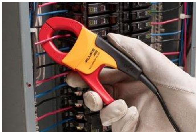
Рисунок 7 – Датчик тока, используемый для измерения тока через проводник
