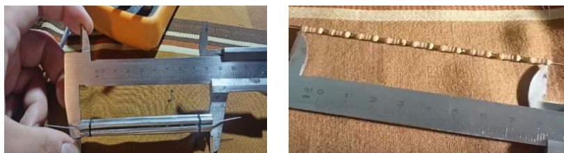
Рисунок 1 – Экспериментальная конструкция для фиксации провода во время нагрева.
