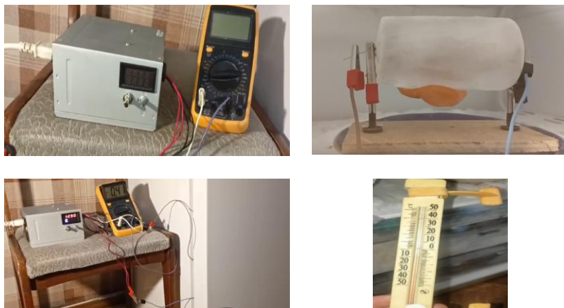
Рисунок 3 – Лабораторная схема плавки гололёда.
