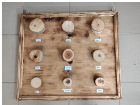
Рисунок 1 – Интерактивный стенд для идентификации пород древесины
