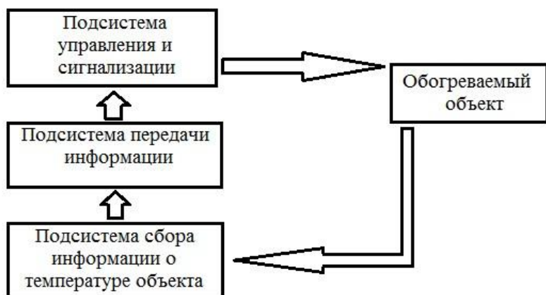
Рисунок 1 – Структурная схема управляющей электрическим обогревом системы
