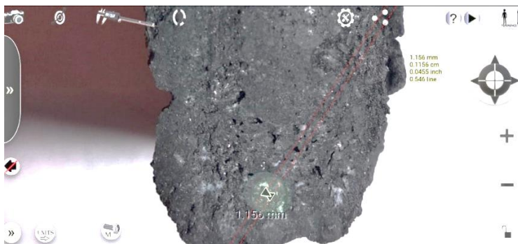
Рисунок 4 – Фрагмент поверхности образца катодного блока с содержанием графита 70%
