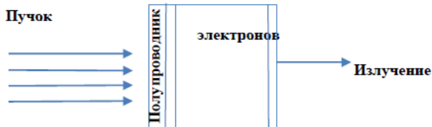
Рисунок 3 – Продольная накачка электронным пучком охлаждение полупроводника. Пример такого лазера – лазер на сульфиде кадмия, генерирующий излучение с длиной волны 0,49 микрон и имеющий КПД около 25%
