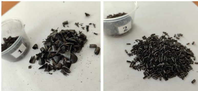
Рисунок 4 – Стружки после механической обработки на разных скоростях резания: №1 \vartheta = 900 об/мин; №2 \vartheta = 2000 об/мин
