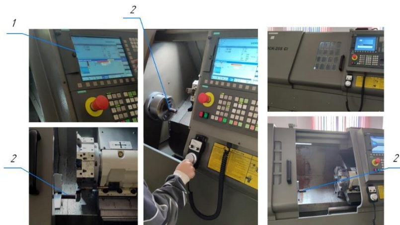
Рисунок 2 – Механическая обработка на станке: 1 – панель управления; 2 – обрабатываемая деталь
