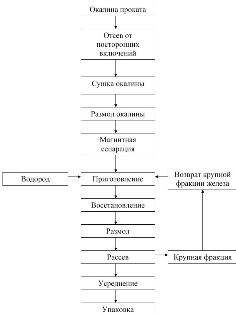
Рисунок 9 – Технологическая схема получения порошков железа из окалины Узбекского металлургического меткомбината
