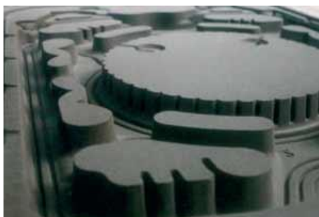
Рисунок 1 – Иллюстрация высшего качества уплотнения песчано-глинистых форм по Сейатцу-процессу на автоматической формовочной линии фирмы HWS-Sinto, Германия
