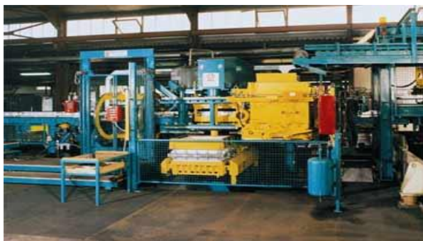
Рисунок 4 – Работающая формовочная машина по Сейатцу-процессу, тип HSP-D и ее схема
