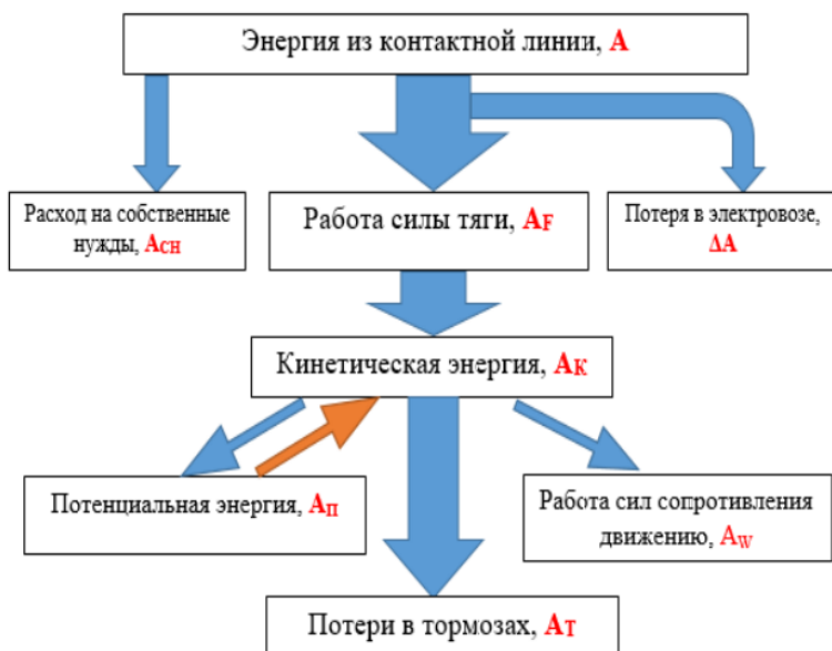
Рисунок 1 – Энергетика движения поезда при электрической тяге
