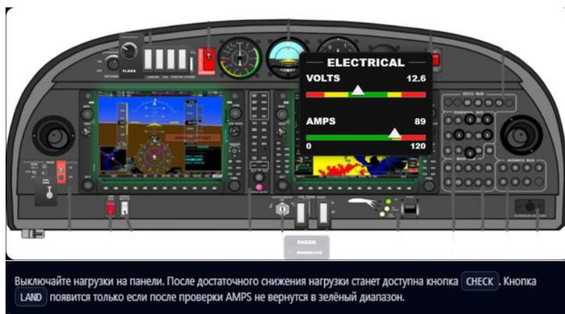
Рисунок 5 – Интерфейс тренажёра «Высокий ток генератора»
