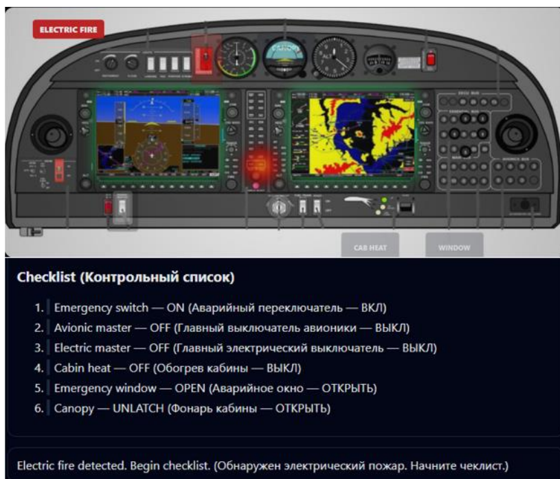
Рисунок 6 – Интерфейс тренажёра «Пожар электросистем»
