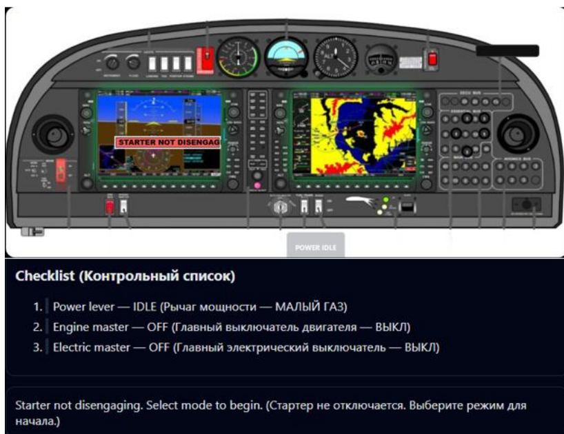
Рисунок 7 – Интерфейс тренажёра «Отказ стартера»
