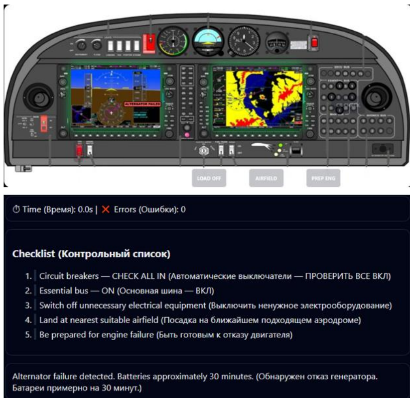
Рисунок 3 – Интерфейс тренажёра «Отказ генератора»
