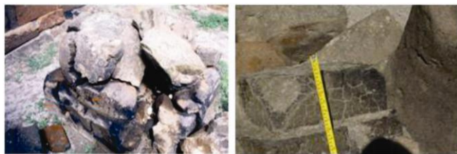
Рисунок 2 – Следы воздействия огня на туфовых фрагментах храмового комплекса Звартноц.
