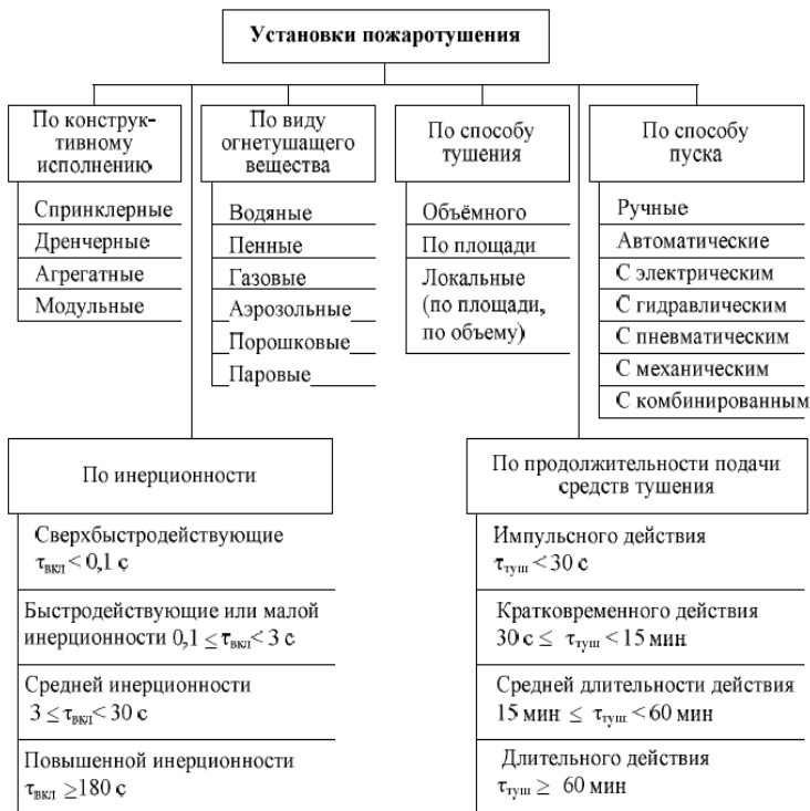
Рисунок 1 – Обобщенная классификация установок пожаротушения
