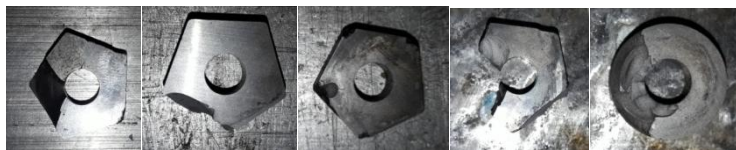
Рисунок 1 – Характерные виды износа и разрушения сменных многогранных пластин
