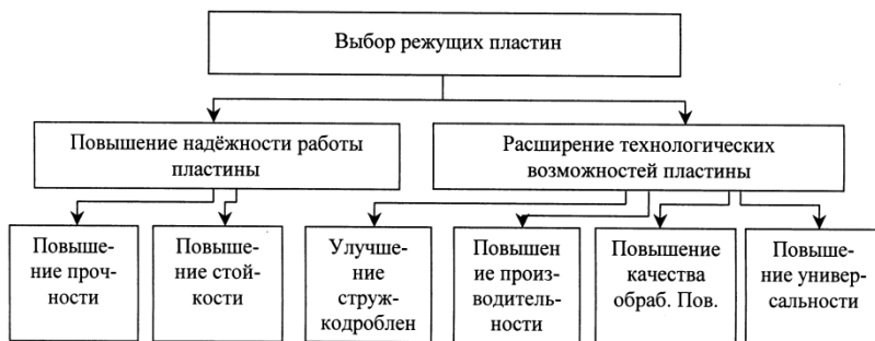
Рисунок 4 – Задачи по усовершенствованию и разработке новых конструкций пластин
