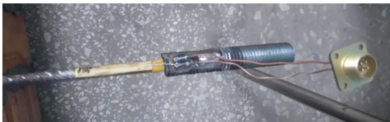
Рисунок 5 – Способ соединения датчика и штекера
