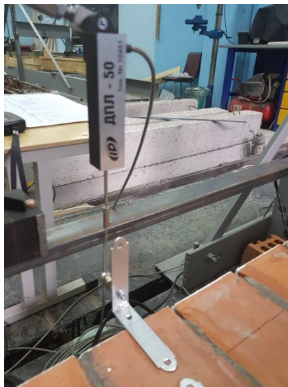
Рисунок 8 – Узел крепления прогибомера к испытываемой балке.
