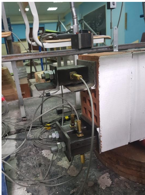
Рисунок 7 – Соединение шпильки и рабочей арматуры.
