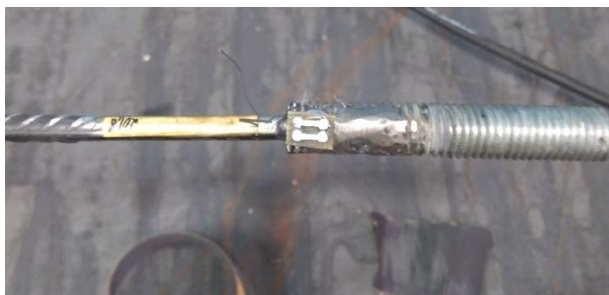
Рисунок 4 – Крепление тензорезисторов на арматуру
