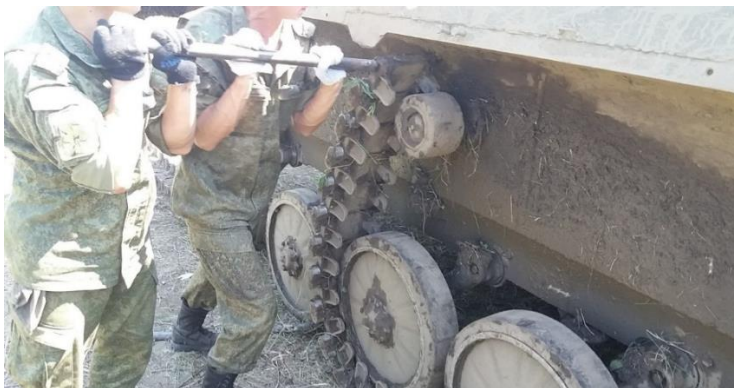
Рисунок 2 – Направление гусеницы на поддерживающий каток
