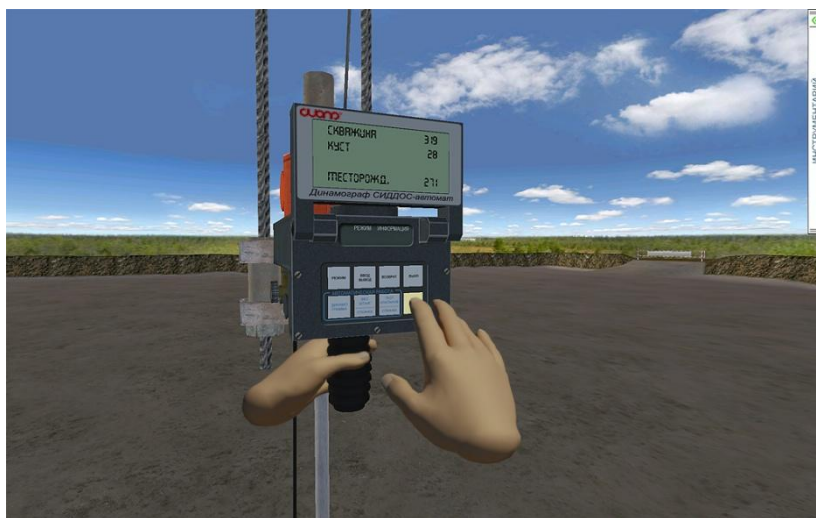
Рисунок 3 – Демонстрация управления при помощи двух виртуальных перчаток
