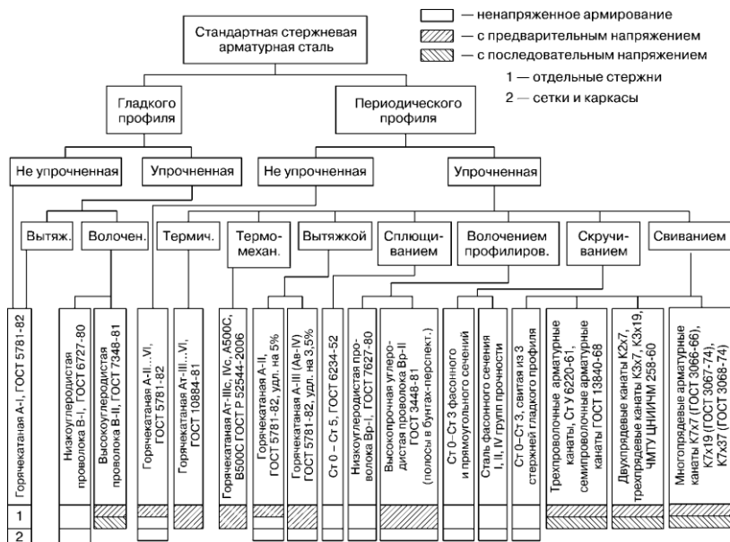
Рисунок 2 – Виды арматурной стали и её применение
