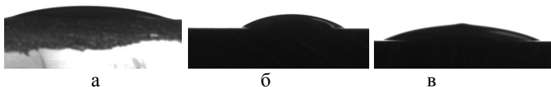
Рисунок 1 – Лежащая капля эпоксидного полимера на твердой поверхности: а) стеклянная поверхность; б) стальная поверхность; в) алюминиевая поверхность
