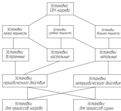
Рисунок 1 – Классификация электромагнитных установок для термической обработки объектов
