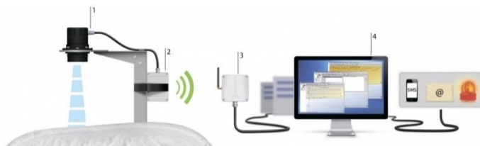
Рисунок 1 – Компоненты системы: 1 – датчик дистанции; 2 – блок управления датчика дистанции; 3 – блок сбора информации; 4 – промышленный компьютер
