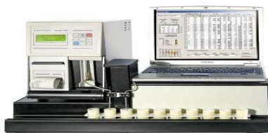
[7] Ультразвуковой анализатор качества молока "Лактан 1-4"
