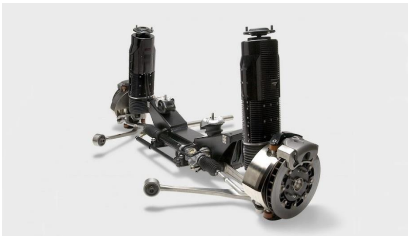
Рисунок 1 – Конструкция подвески Bose
