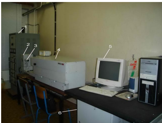
Рисунок 5 – Спектрофотометр МФС-7 и его составные части. 1 – источник возбуждения спектров; 2 – штатив для прожига масла; 3 – дифракционная решетка; 4 – полихроматор (фотоэлектрический умножитель); 5 – компьютер; 6 – интегратор (интерфейс).
