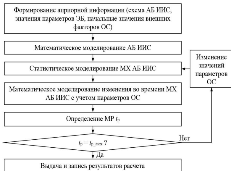
Рисунок 1 – Алгоритм обеспечения максимального МР АБ ИИС
