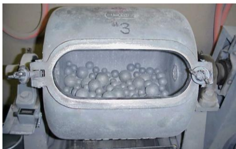
Сурет 1.2 – Барабанды диірмендегі шарлы жүктеменің жалпы көрінісі
