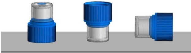
Рисунок 2 – Вероятные положения ступенчатого колпачка на дне бункера БЗУ
