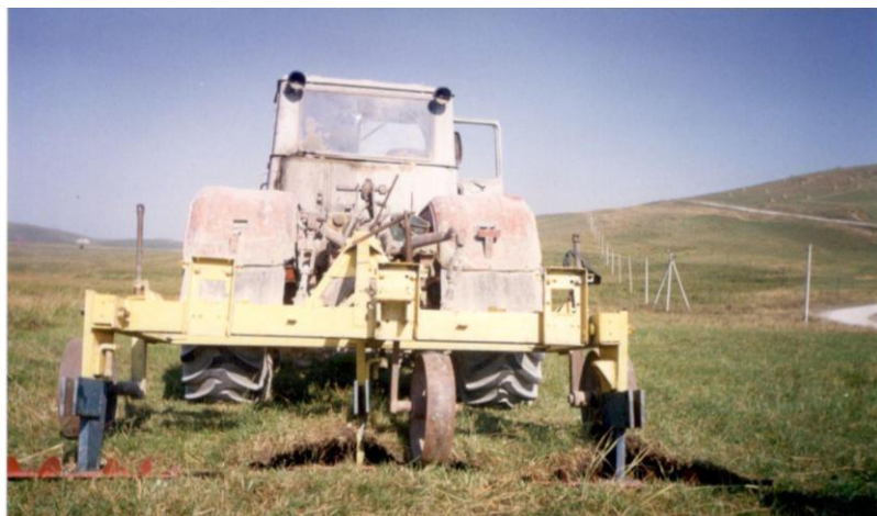
Рисунок – Предварительные полевые исследования плоскореза для улучшения горных кормовых угодий
