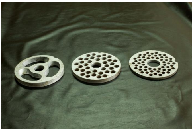
Рисунок – 4 Решётка измельчителя а) входная; б) промежуточная; в) выходная
