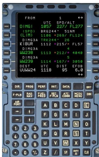
Рисунок 2 – Данные по расходу топлива на схеме с использованием CDO
