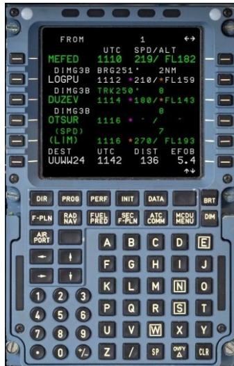
Рисунок 1 – Данные по расходу топлива на традиционной схеме прибытия DIMGI 3B
