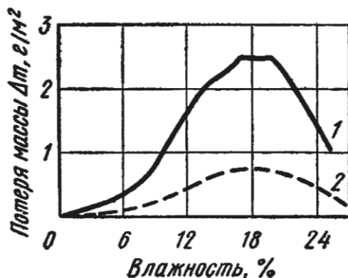
Рисунок 1 – Влияние степени влажности почвы на скорость почвенной коррозии стали: 1 – в песке; 2 – в глине [3, С.387]
