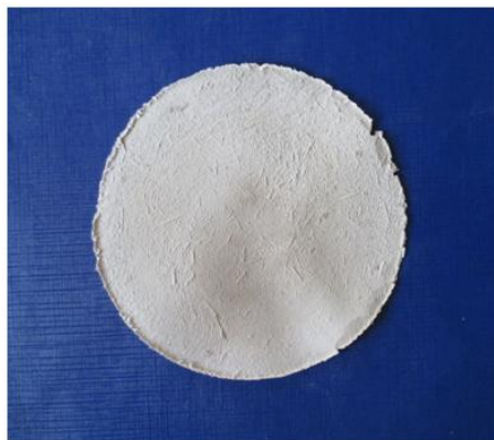
Рисунок 22 – Образец листового материала, полученный из состава с соотношением ППС к \text{Na}_2\text{S} , как 10:1
