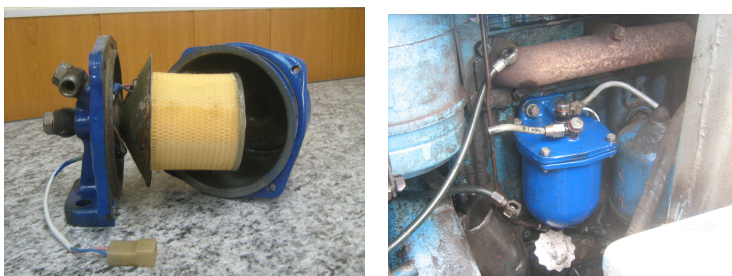
Рисунок 1 – Фильтр-нагреватель по патенту РФ (RU 2112582 CJ01D29/48): а) общий вид фильтра-нагревателя; б) фильтр установлен на трактор
