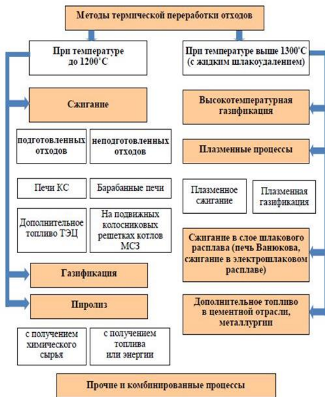
Рисунок 4 – Классификация термических методов переработки отходов
