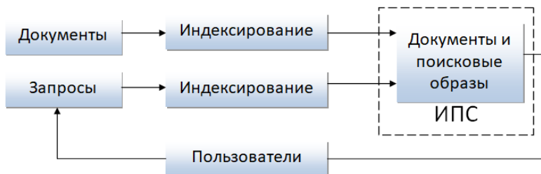
Рисунок 1 – Принцип работы системы индексирования
