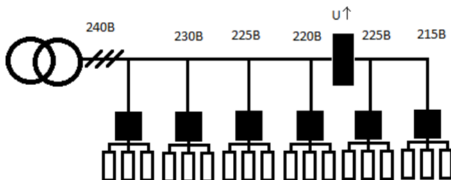
Рисунок 2 – Использование вольтодобавочного трансформатора
