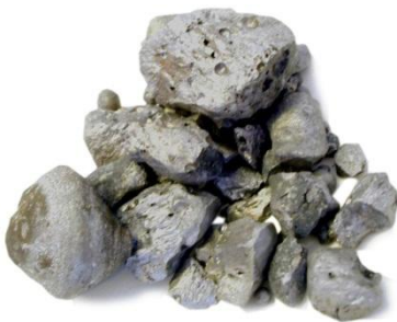
Рисунок 1 – Лигатура, получаемая из циркониевого концентрата Алгаминского месторождения
