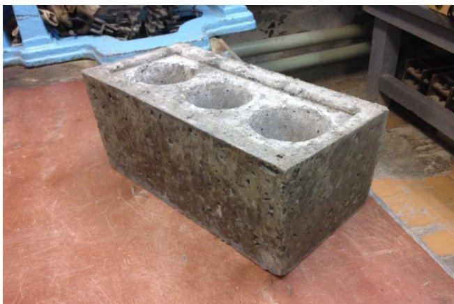
Рисунок 2 – Опытный образец камня шламобетонного стенового
