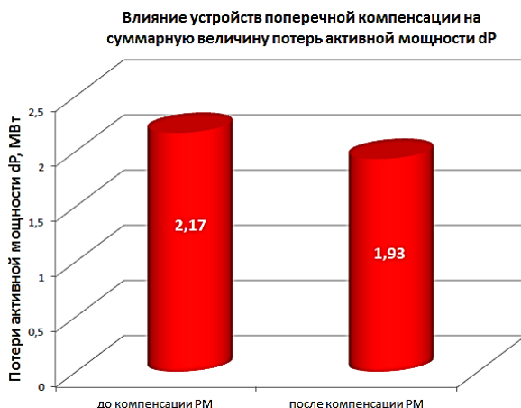
Рисунок 4 – Влияние устройств поперечной компенсации на потери активной мощности в сети
