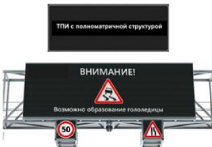
Рисунок 4 – Пример табло переменной информации (ТПИ) с полно-матричной структурой
