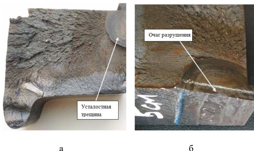
Рисунок 3 – Внешний вид излома бандажа №42: а – усталостная трещина; б – очаг разрушения
