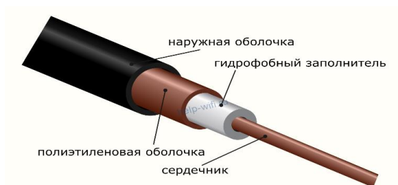
Рисунок 1 – Оптоволокно в разрезе
