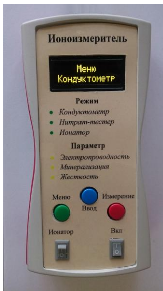
Рисунок 3 – Электрометрический ионоизмеритель, патент №152732
