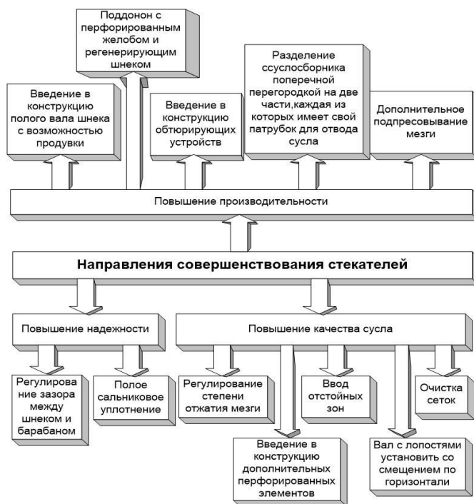
Рисунок 2 – Направления совершенствования шнековых стекателей
