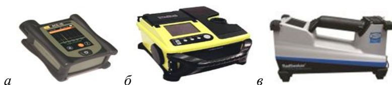
Рисунок 4 – Портативные устройства для обнаружения взрывчатых, опасных химических и радиоактивных веществ: а – ACE-ID; б – GC/MS; в – RadSeeker
