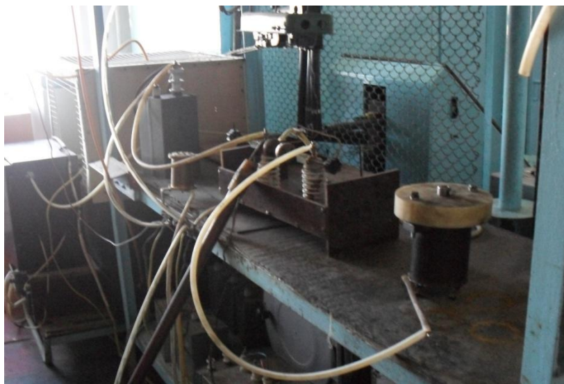
Сурет1 – Кенді бұзып үгудің тәжірибелік стендісінің жалпы бейнесі
