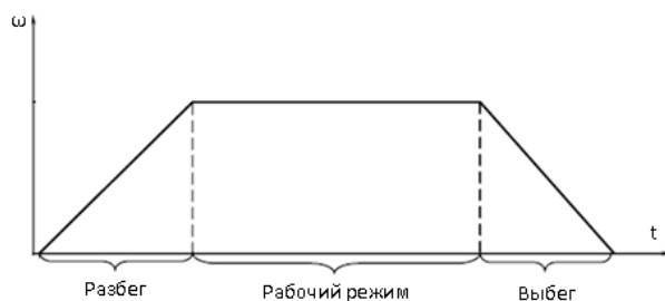
Рисунок 8 – Зависимость изменения угловой скорости вращения ротора
