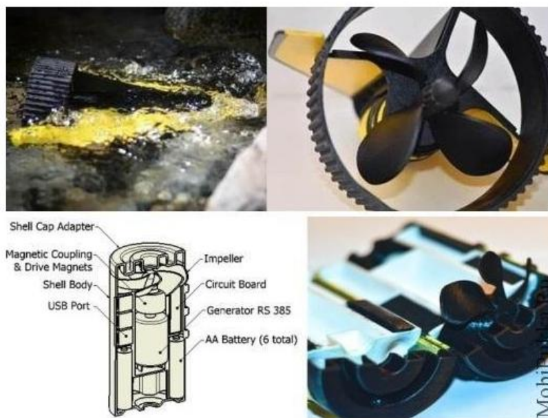
Рисунок 3 – Внутренние устройства гидрогенератора HydroBee
