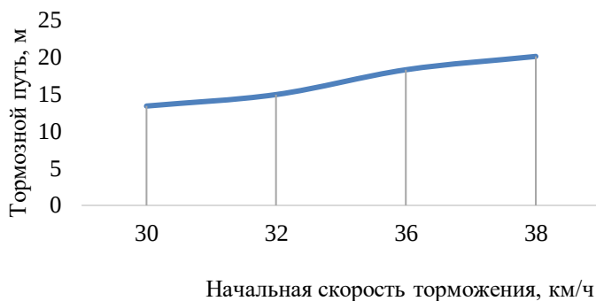
Рисунок 4 – График зависимости тормозного пути от начальной скорости торможения
